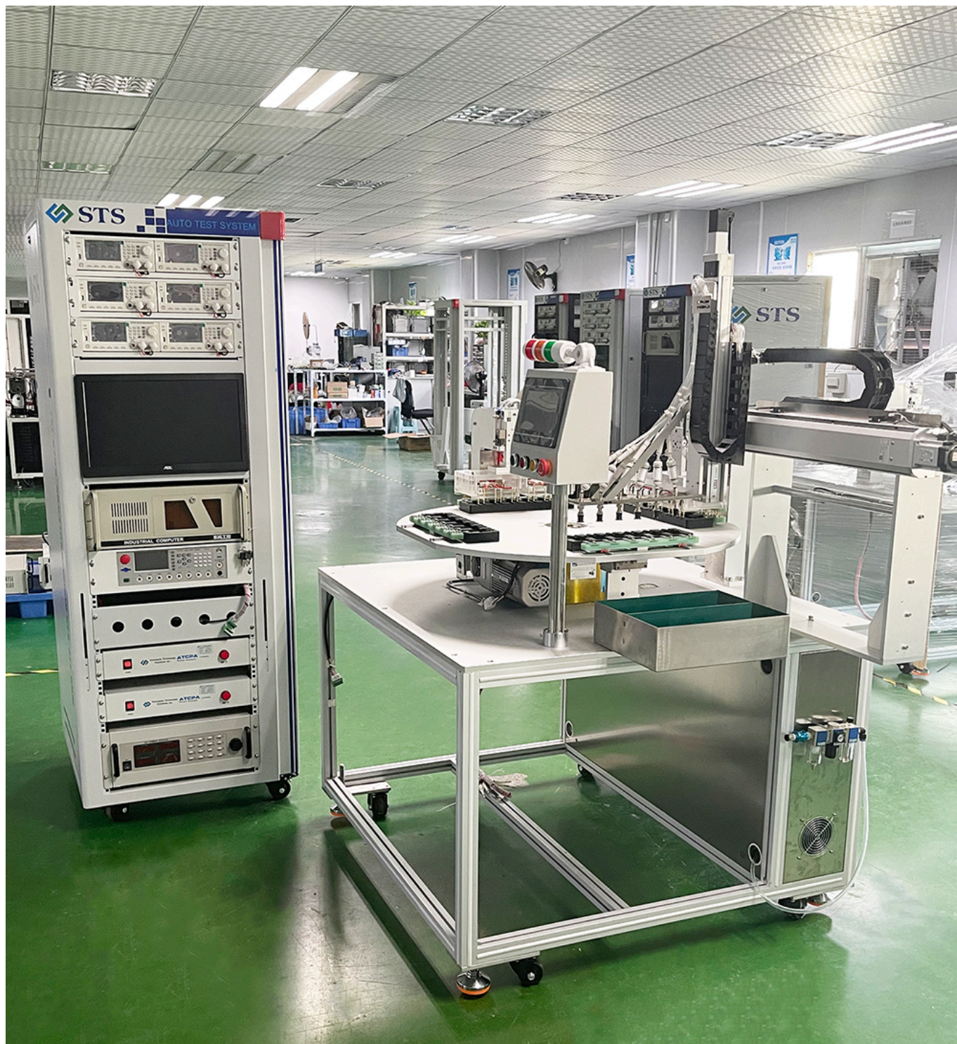
转盘机+ATE 测试系统
